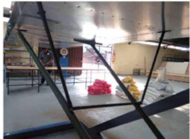
Figura 24. Instalación de *Jury Struts*
