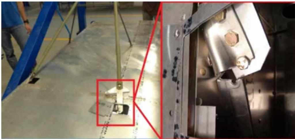
Figura 27. Elemento fallido bajo carga última: conexión entre el strut y el ala
