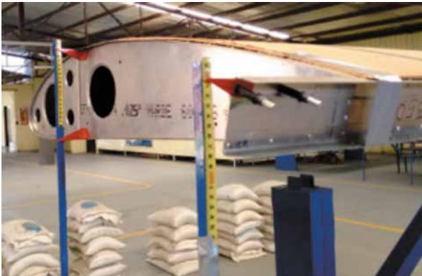
Figura 19. Método real de medición de las deflexiones
