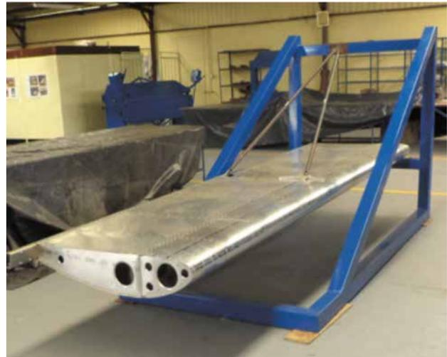
Figura 21. Montaje para carga de maniobra positiva
